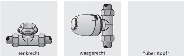
Der OEM-Antrieb ist bevorzugt in senkrechter und waagerechte Montagelage einzubauen. Bei "über Kopf"-Montage können spezielle Umstände (z.B. Schmutzwasser) die Lebensdauer reduzieren.
